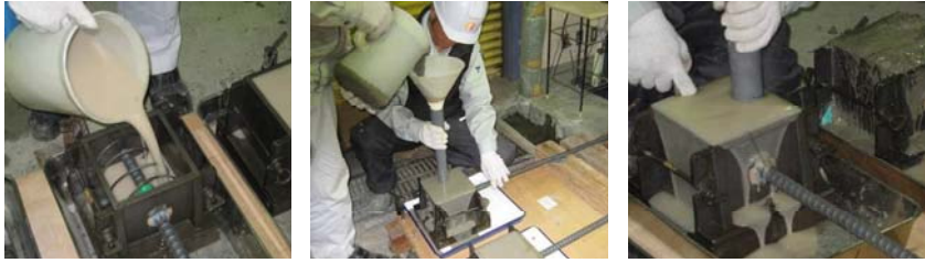
①安定液充てん ②コンクリートの打設 ③コンクリート置換完了 写真 1-2-3 供試体作成状況
