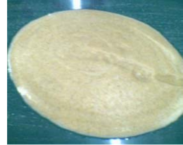
写真-2 気泡混合土
