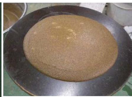
写真-2 気泡混合土
